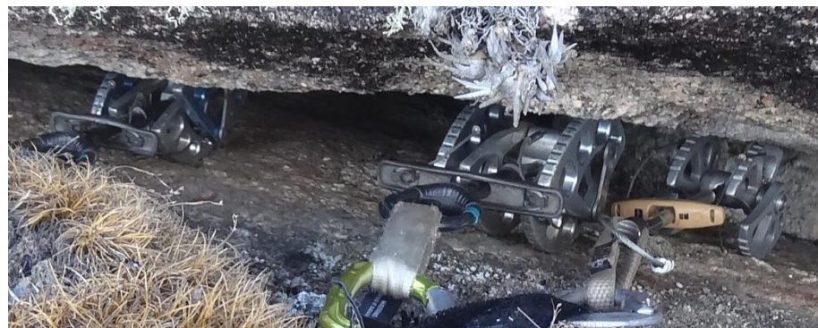
Parada Móvel com dois Camalots e um Friend
