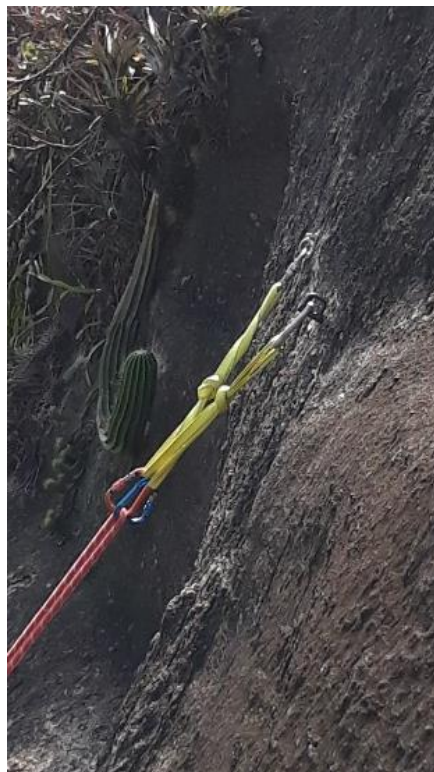
Quad com anel de fita e dois mosquetões de rosca invertidos
