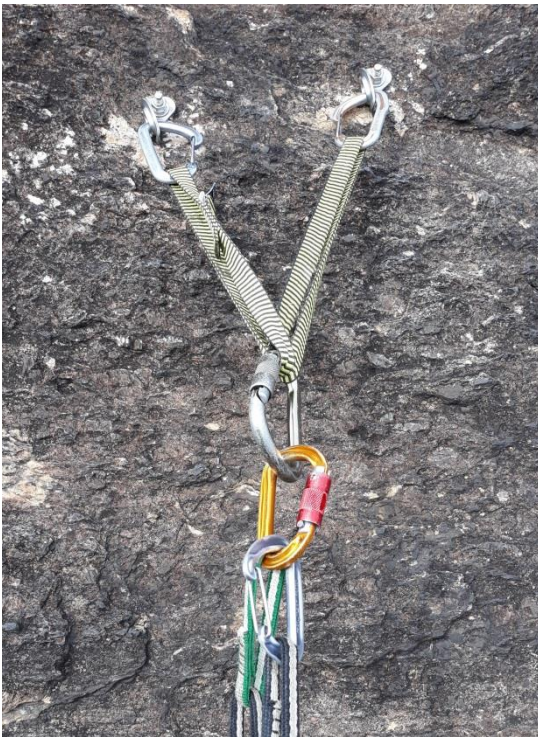
Parada feita com X Mágico, onde o mosquetão HMS é o Master Point
