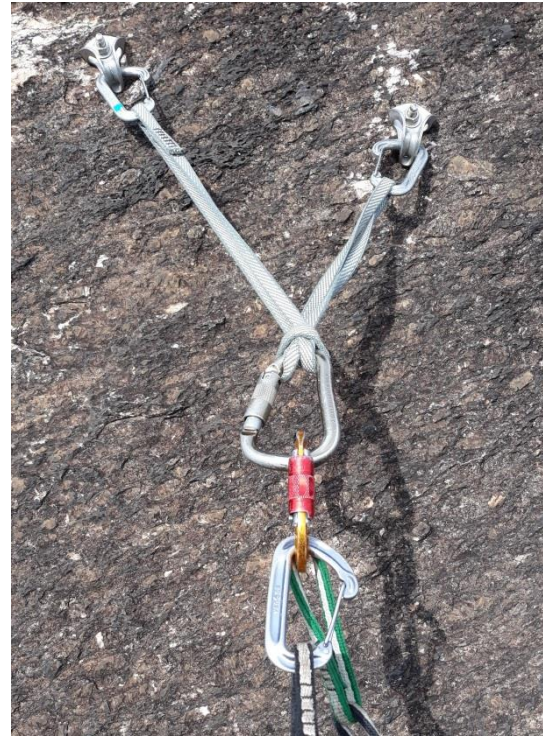
Parada feita com Boca de Lobo, onde o mosquetão HMS é o Master Point
