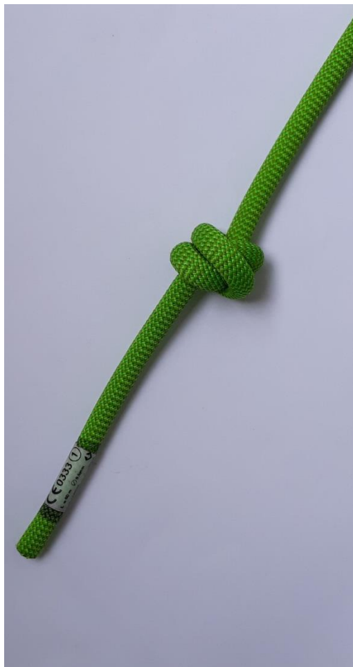
Nó de Frade Usado na ponta da corda durante o rapel
