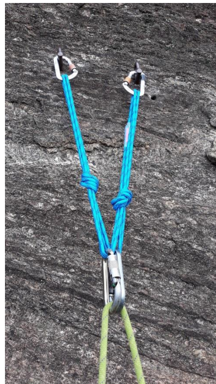
Quad com cordelete de 7mm e dois mosquetões de rosca invertidos
