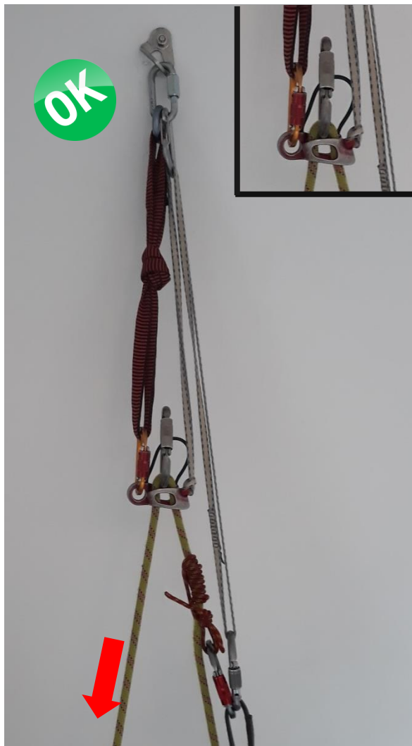
Forma correta de liberar o ATC Guide na função autoblock
