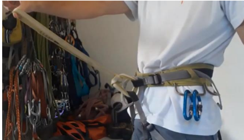
Anel de Fita de 80cm conectada nas duas alças de segurança da cadeirinha
