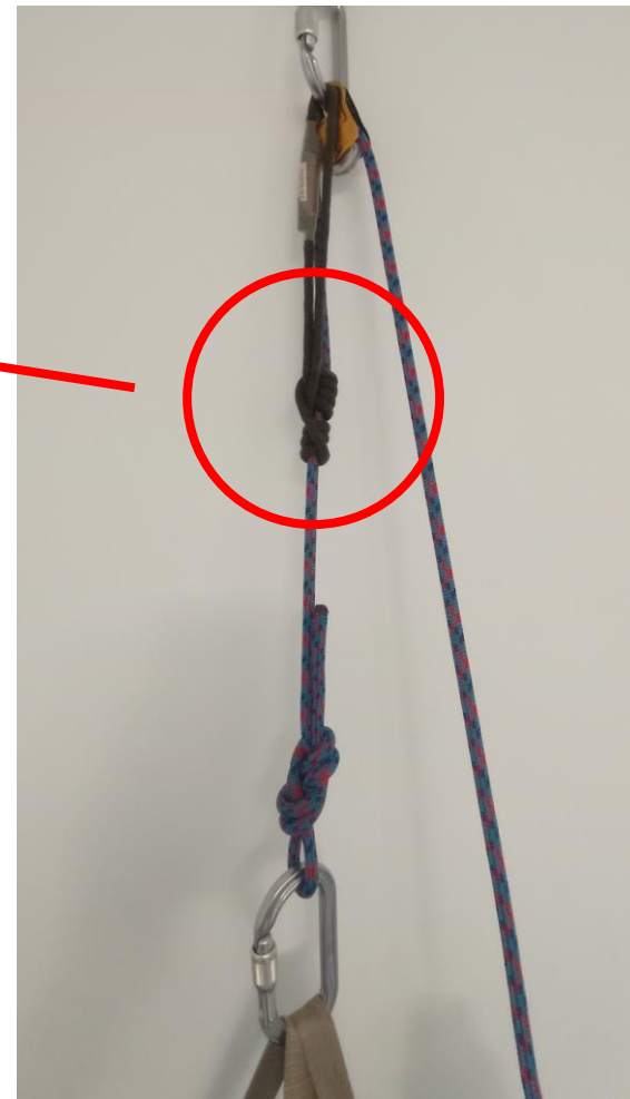
Sistema de içamento bloqueado na direção oposta
