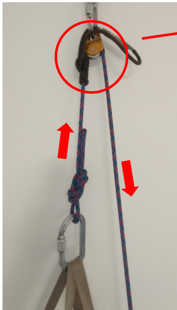
Sistema de içamento liberado para a direção desejada
