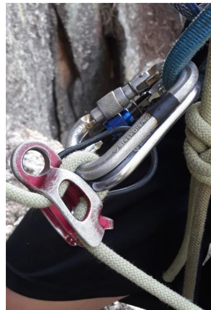
Na foto acima o escalador utilizou dois mosquetões no freio tipo ATC para aumentar o atrito na corda.
