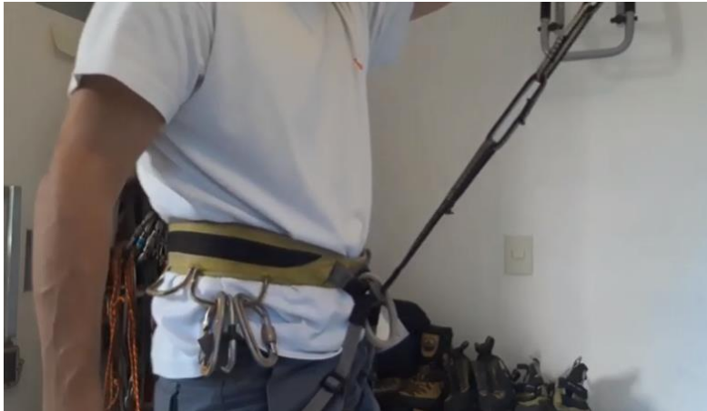
Metolius PAS 22 conectada nas duas alças de segurança da cadeirinha
